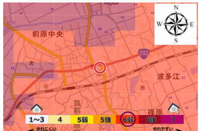
**<解説>** 「ゆれやすさ」とは、地震による地表面のゆれやすさを示します。一般的に、同じ地震でも平野や川に沿った地域、人工的に土を盛った造成地など、地表面（表層地盤）が軟らかい場所は、固いところよりも揺れやすい傾向にあります。
